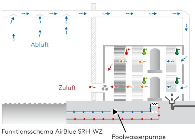
Die Schwimmbadentfeuchter der **Serie AirBlue SRH** wurden speziell für den Einsatz in mittleren bis größeren Bädern in privaten und öffentlichen Bereichen entwickelt, wo es darum geht, den Grad der Luftfeuchtigkeit zu kontrollieren, der Kondensatbildung vorzubeugen und ein optimales Raumklima zu gewährleisten.
