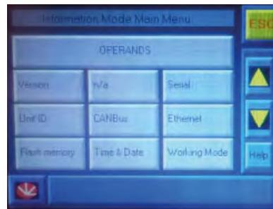
Alle AirBlue Luftentfeuchter der Baugröße AT 1300/ AT 2300/AT 3300 und AT 3500 sind mit der neuen **SPS-Steuerung** ausgestattet. Die Steuerung ist mit einem 3,5 Zoll großen 16-bit-Farb-Touchscreen ausgerüstet und entspricht der Schutzklasse IP66.
