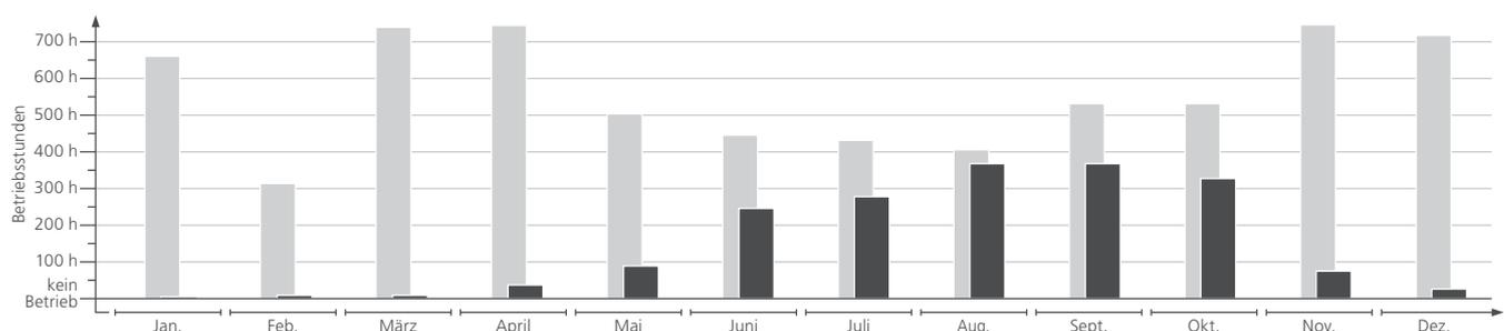
In einem Wasserwerk in Nordrhein-Westfalen wurden über vier Jahre Langzeitmessungen an den dort eingesetzten Luftentfeuchtern durchgeführt. Durch den Einsatz von Taupunktfühlern konnte die Laufzeit der Geräte um bis zu 5.254 Std/Jahr reduziert werden. Setzt man für den Strompreis einen Betrag von 20 Cent an, so entspricht dies einer Einsparung von 1.693,00 € pro Gerät und Jahr.
