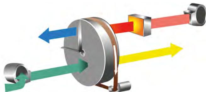
Alle AirBlue Adsorptionstrockner sind mit einem hochwertigen Silicagel-Rotor ausgestattet und garantieren eine hohe Trocknungskapazität sowie einen wirtschaftlichen Betrieb. Der zweizonige Entfeuchtungsrotor besteht aus einem Faservlies keramischen Ursprungs, in dem das stark wasseranziehende Trockenmittel (Silicagel) chemisch eingelagert ist.
