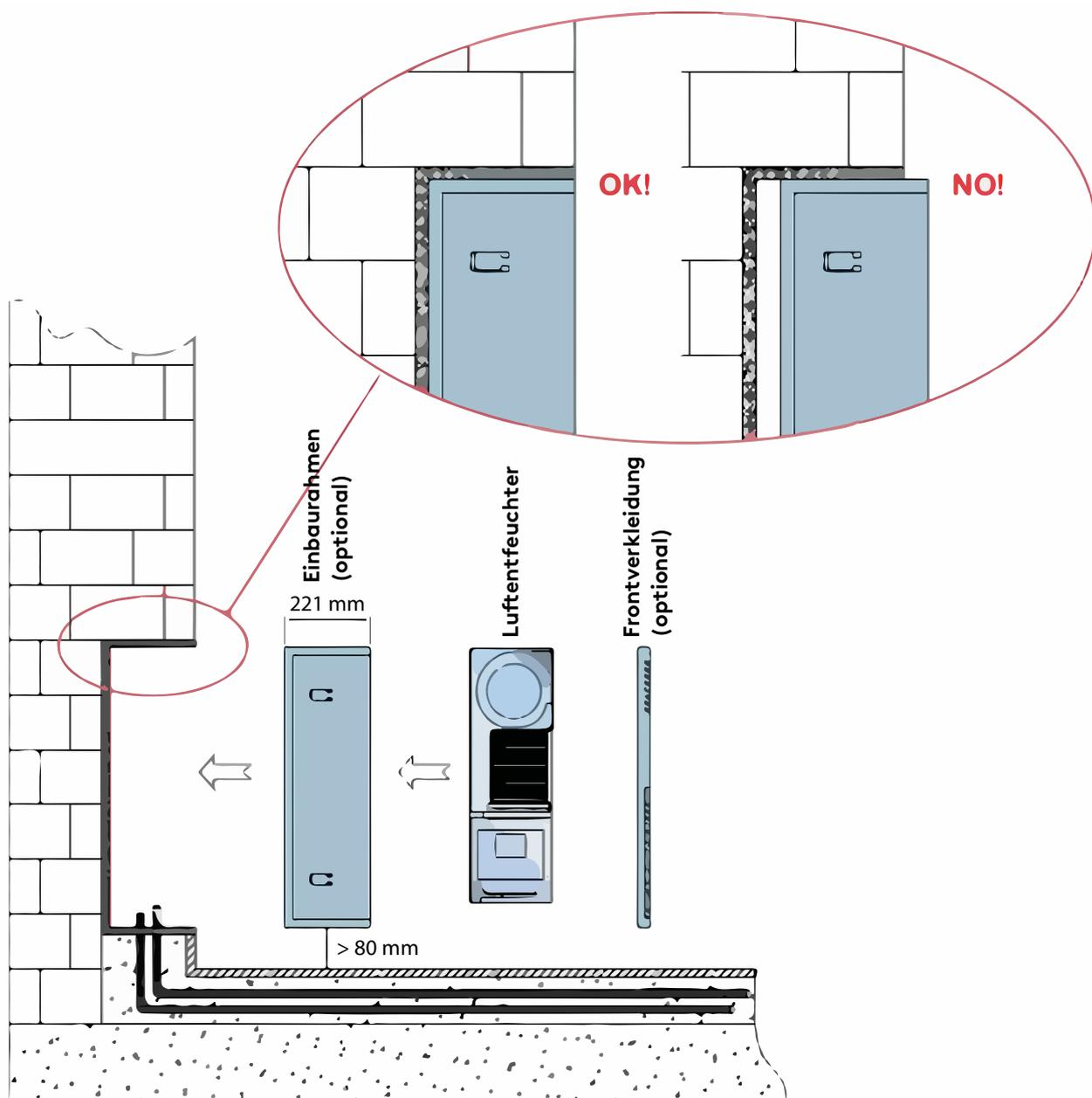
Beispiel für eine typische Montage des Luftentfeuchters in der Wand mit optionalen Einbaurahmen und Frontverkleidung.
