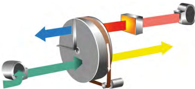
Alle AirBlue Adsorptionstrockner sind mit einem hochqualitativen Silicagel-Rotor ausgestattet und garantieren eine hohe Trocknungskapazität sowie einen wirtschaftlichen Betrieb. Der zweizonige Entfeuchtungsrotor besteht aus einem Faservlies keramischen Ursprungs, in dem das stark wasseranziehende Trockenmittel (Silicagel) chemisch eingelagert ist.
