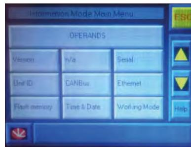
Diese AirBlue Luftentfeuchter sind mit der neuen **SPS-Steuerung** ausgestattet. Die Steuerung ist mit einem 3,5 Zoll großen 16-bit-Farb-Touchscreen ausgerüstet und entspricht der Schutzklasse IP66.
